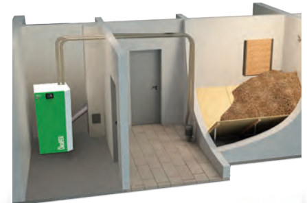
Succión neumática con silo de obra
